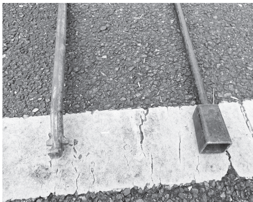
消火栓キー(写真左)と消火栓ハンドル
