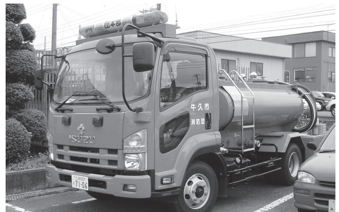
3.5トンの水を積載できる小型ポンプ付水槽車
