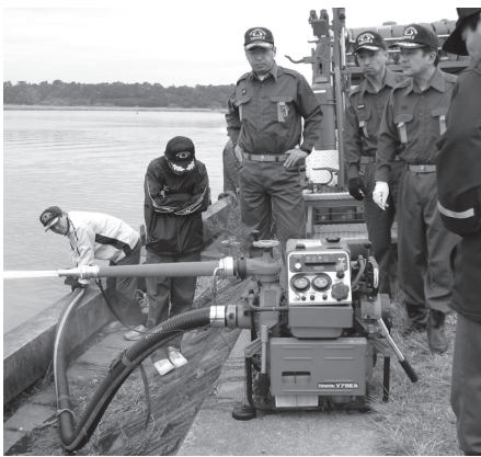
大切な消防ポンプの点検
