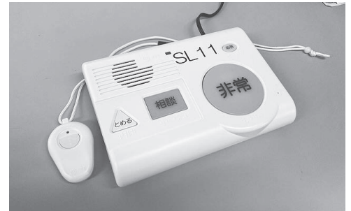
緊急通報装置
