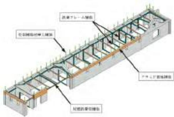
図 1-19 貯蔵庫 補強概要図
