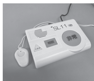
簡単な操作で消防本部に通報できる緊急通報装置
