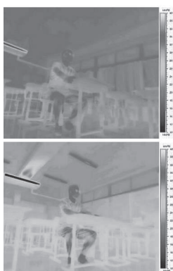
さいたま市立芝川小学校で行われた実証実験。上下ともエアコン稼働時。上は断熱対策前で、下は対策後。エアコンの送風口のあたりで20度以下。教室全体で、色の薄い部分は22度から30度以下、色の濃い部分は30度から38度くらいまでを表示。
