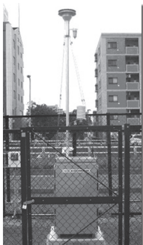
ひたち野リフレ駐車場内 PM2.5測定機
